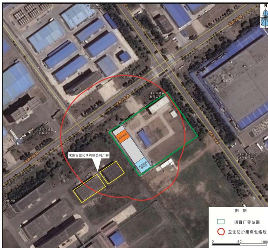
图 6-1 建设项目卫生防护距离包络线图
